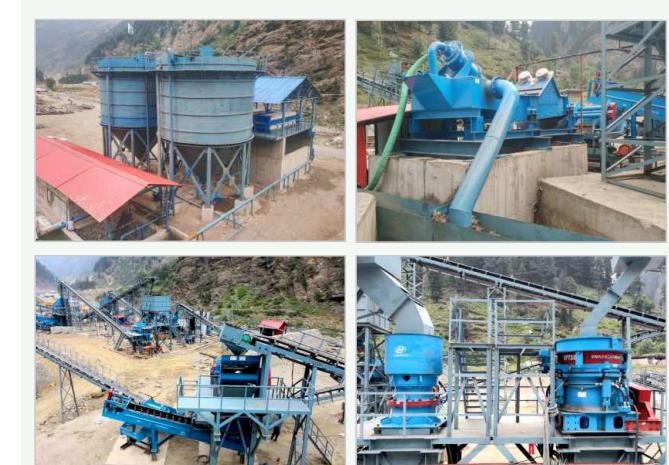
2018年8月，由洛阳大华集团公司提供设计、供货的砂石骨料加工生产线在巴基斯坦SK水电站开始试运行，本系统为时产90吨砂石骨料生产线系统，包含颚式破碎机、单缸圆锥破碎机、多缸圆锥破碎机、制砂机、集装箱电控及污水处理系统。
