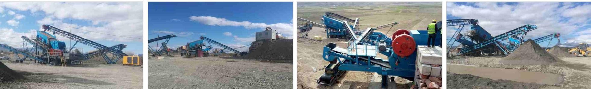
在美丽的亚欧大陆交界处新增一片大华蓝，连续两年我们在这片美丽的土地上建设了两条生产线。主要设备有：ZSW4211给料机、ASD3625颚破、3YKR1854振动筛、DHKS5112颚破、PFQ1315C反击破、2YKR2160振动筛、洗砂机、配套移动拖车、皮带机以及全套移动集中控制系统。
