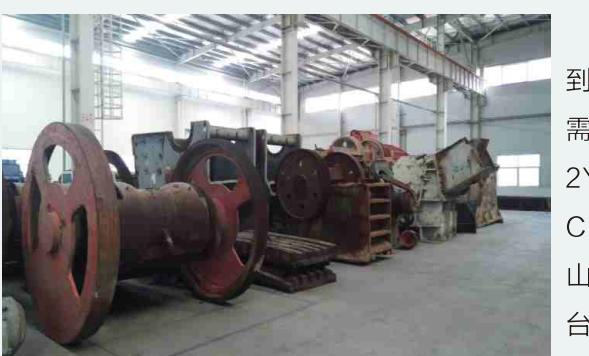
10月中旬洛阳瑞克循环到了某国有的维修订单，需要维修的该批设备有2YK1650振动筛一台、山特CJ613大型颚式破碎机两台、山特CH440圆锥破碎机一台、美卓NP1315反击破碎机一台。
